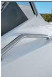
Há pegadores na popa, finca-pés e corrimãos no console central e nas amuradas, todos em inox 316, o que garante ótima resistência à corrosão. Os cunhos são adequados em tamanho e quantidade. E a estrutura da capota, que é opcional, é de alumínio, robusta e leve.
