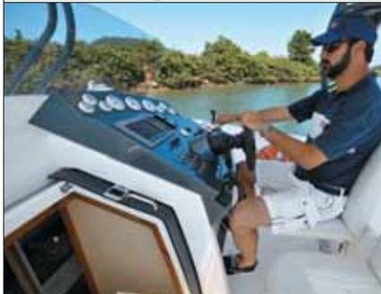
O posto de comando é bom, com dois bancos com assentos rebatíveis para baixo, bons para pilotar em pé. O painel de instrumentos é grande, com lugar para todos os instrumentos dos motores, monitor de nove polegadas, rádio vhf e disjuntores.
