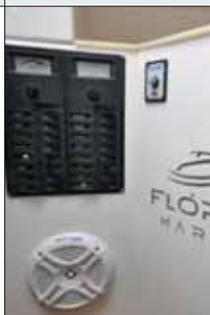
A fiação não é codificada, mas é estanhada e com conexões soldadas e isolamento apropriado. As luzes a bordo são de leds, que consomem menos energia. O painel elétrico fica bem visível, ao lado da escada da cabine. Já as baterias são três, de 150 Ah, sendo uma de serviço e duas para os motores.
