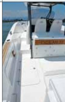
É primorosa. A laminação é manual, com fundo em fibra maciça reforçada por tecidos multiaxiais e costado em sanduíche de fibra de vidro e espuma de pvc, para maior leveza do casco. O estaleiro oferece opção de laminação por infusão, que deixa o casco 15% mais leve.
