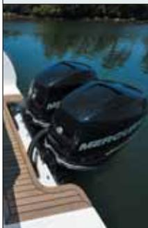
Pode ser um ou dois de centro-rabeta, com 350 a 600 hp no total, ou então dois — ou três! — de popa, de 225 a 300 hp cada. No barco testado, com dois de popa de 250 hp, a montagem estava benfeita e os comandos eletrônicos dos motores tornaram a pilotagem mais gostosa.
