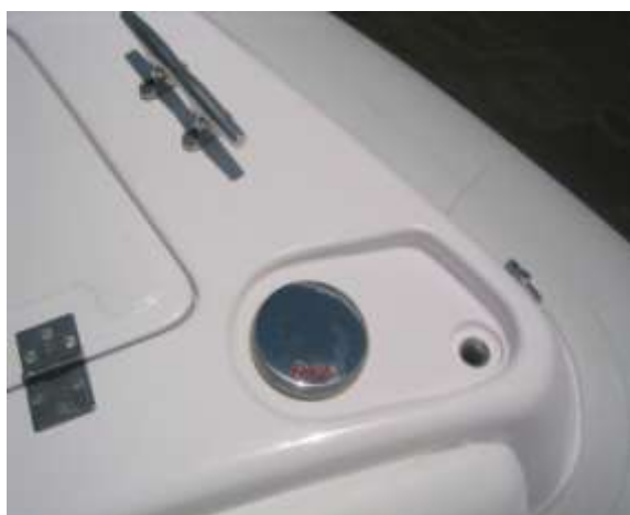
Bocal de abastecimento e dreno
