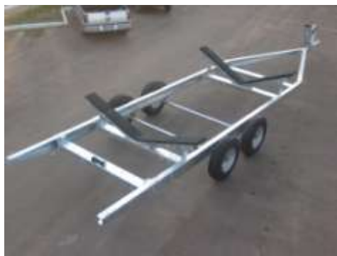
Carreta rodo-encalhe galvanizada a fogo
