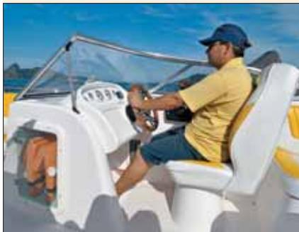
O banco do piloto não tem qualquer regulagem. Ainda assim, é confortável para pilotar sentado e não atrapalha quando em pé no volante. Em compensação, o para-brisa atrapalha um pouco a visão do piloto. Já o manete do acelerador fica muito próximo do para-brisa lateral, o que dificulta o seu manuseio.
