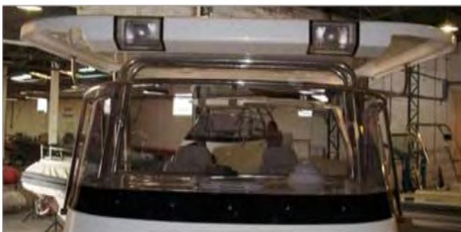
Farol de milha embutido com proteção de acrílico
