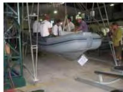
Teste de içamento com carga total
