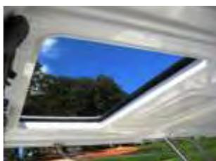
Teto solar elétrico – Acionado por um único toque no botão instalado na console de teto. Possui sistema anti-esmagamento ao ser fechado.
