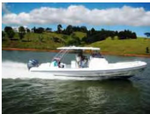
O Hard Top é uma estrutura fixa, super reforçada e com design moderno. Construída em aço inox com cobertura em fibra de vidro proporcionando sombra de 3,53 m X 2,39 m, equipado com console de teto, teto solar elétrico ou fixo, faróis de milha embutido e suporte para instalação de diversos acessórios. Exemplo: radar, luzes de navegação, mastro de bandeira com luz de top, buzina e antenas.
