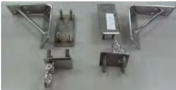
Conjunto de peças que formam o anel de içamento instalado na proa
