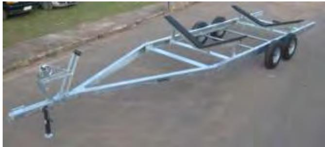
Construída em ferro protegido com galvanização a fogo, com 2 eixos, rodas aro 15", capacidade para 4 toneladas. Vem equipada com: Torre frontal com rolete de borracha, guincho manual e pé de apoio dianteiro
