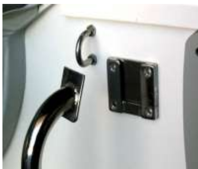
Suporte onde a escada é fixada
