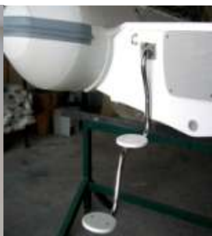
Escada fixada na popa
