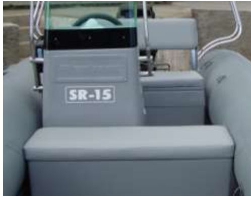
Caixa térmica (Geladeira) com parede dupla e tampa estofada. Formando banco adicional para duas pessoas, na frente da console.
