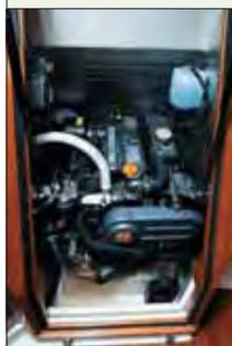
Equipado com um motor Yanmar 3YM30 de 29 hp e rabeta saildrive, chegou a 6,7 nós em velocidade de cruzeiro, o que é uma boa marca. O acesso ao motor não é complicado, bastando levantar a escada que leva à cabine.
