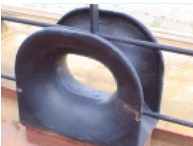
**Buzina** – é uma peça de aço robusta colocada na borda para servir de guia aos cabos de amarração dos navios.
