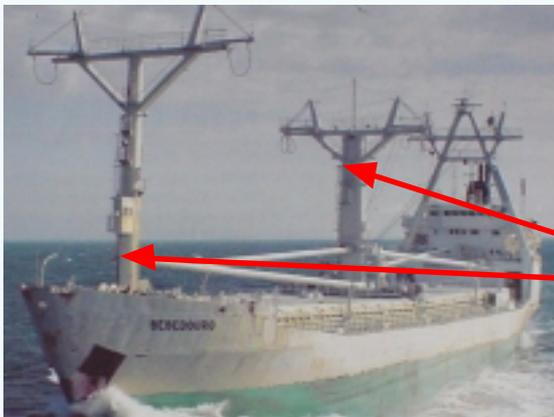
**mastro tubular** - formado por seções de tubo de aço reforçadas por dentro com cantoneiras.
