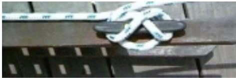
**Cunho** - é um componente no qual fixamos muitos cabos a bordo, inclusive junto aos mastros para a fixação de **adriça** (cabo de içamento) da bandeira.
