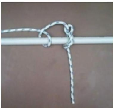
Para aumentar a segurança da **volta da ribeira**, quando se quer içar uma peça cilíndrica, podemos dar mais uma meia volta, como se vê na figura.
