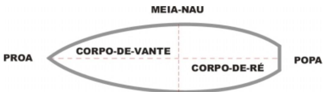
**Proa** – é a região da extremidade de vante da embarcação. Estruturalmente, tem a forma exterior afilada para melhor cortar a água.
