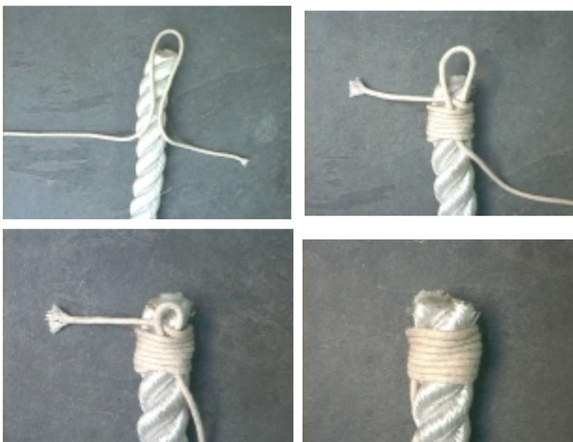
**Falças** – é o meio correto e mais usado para não permitir descochar o chicote de um cabo. Falçar é dar voltas redondas no chicote de um cabo. A figura ao lado apresenta uma das maneiras de falçar o chicote de um cabo.
