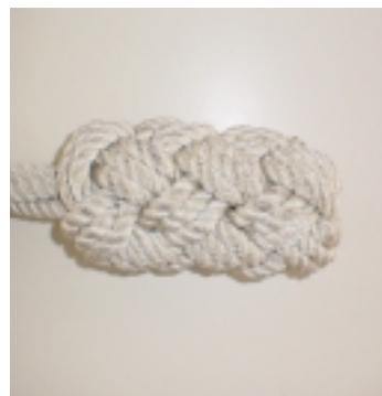
**Defensas** – consistem em sacos de lona forte ou pneus, cheios de cortiça, borracha ou pedaços de cabos, cobertos com embotijo (trançado de cabos para proteção contra desgaste). São usados para proteger a embarcação durante a atracação ou, enquanto estiverem atracadas, para evitar danos à pintura e avarias no costado. A figura ao lado mostra um dos tipos de defesa, conhecida como **defensa da roda**.
