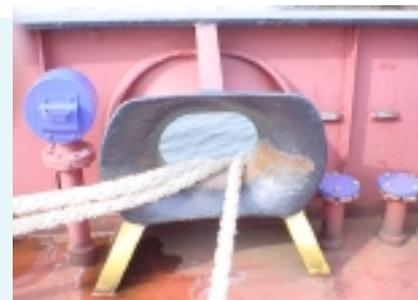
**Tamanca** - É uma peça de metal fixada no convés para passagem dos cabos de amarração dos navios. Serve para substituir uma buzina junto à borda da embarcação, com a vantagem de reduzir o atrito, por possuir roletes ou **rodetes**.
